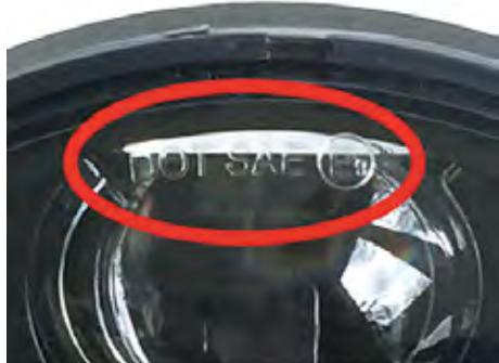
Abbildung zeigt eine Fälschung der ECE Homologations-Kennzeichnungen
