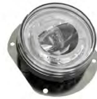
Kompakter 90 mm LED-Nebelscheinwerfer in modularer Bauweise, passend zu allen anderen 90 mm LED- und Halogenscheinwerfern aus der Serie 900. Steuergerät integriert. Scharfe Hell-Dunkel-Grenze. Mit Blechhalter, Verstellung oben und unten möglich. Bewährt im Serieneinsatz bei Fahrzeugherstellern. 2D Zeichnungen, 3D CAD Daten und weitere Daten auf Anfrage verfügbar.
