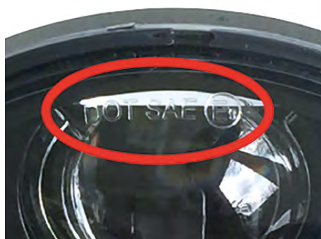
Abbildung zeigt eine Fälschung der ECE Homologations-Kennzeichnungen
